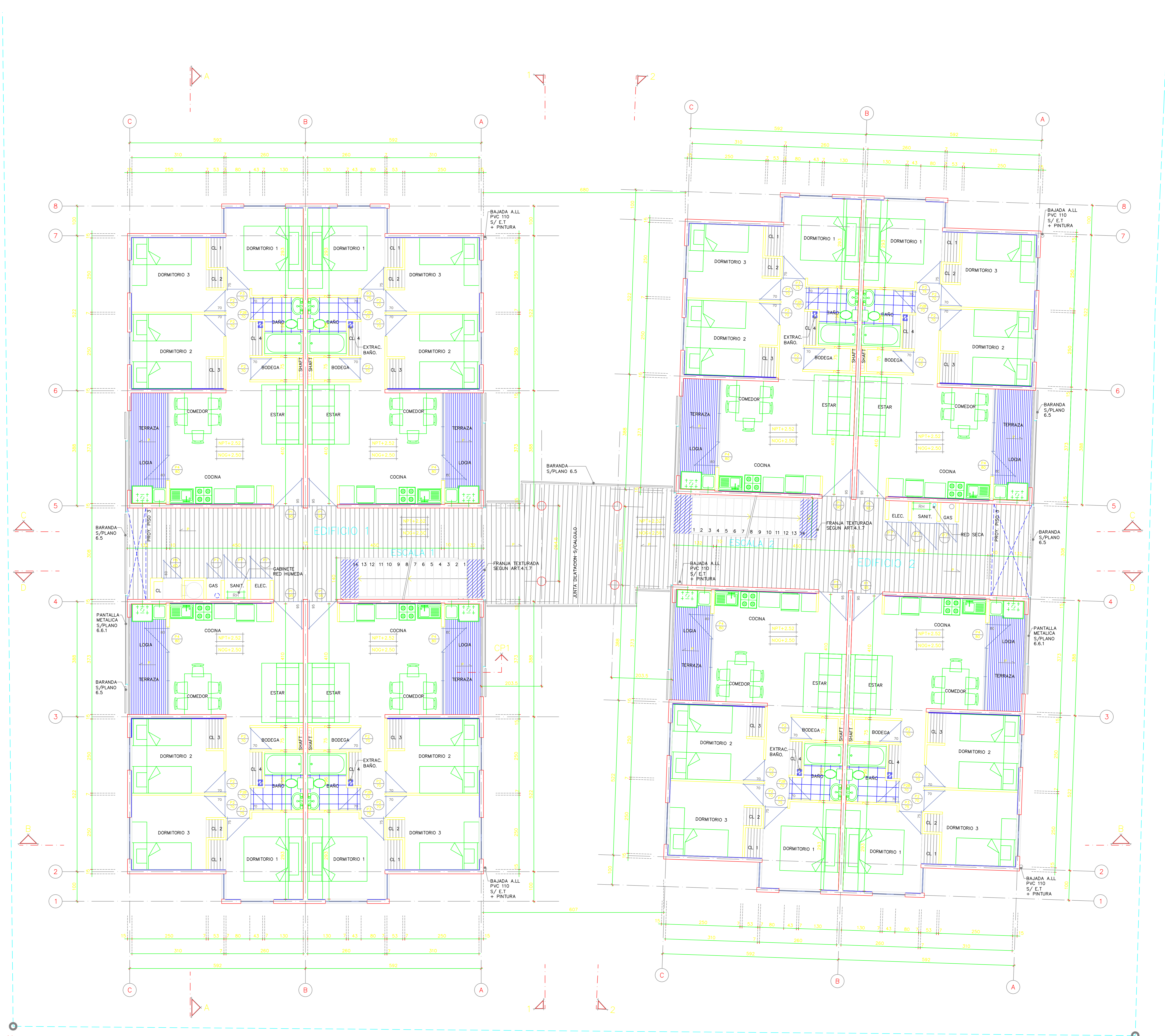
PLANTA PISO 2 PISO 2 = NOG+2.50 = NPT+2.52 ESC. 1:50
